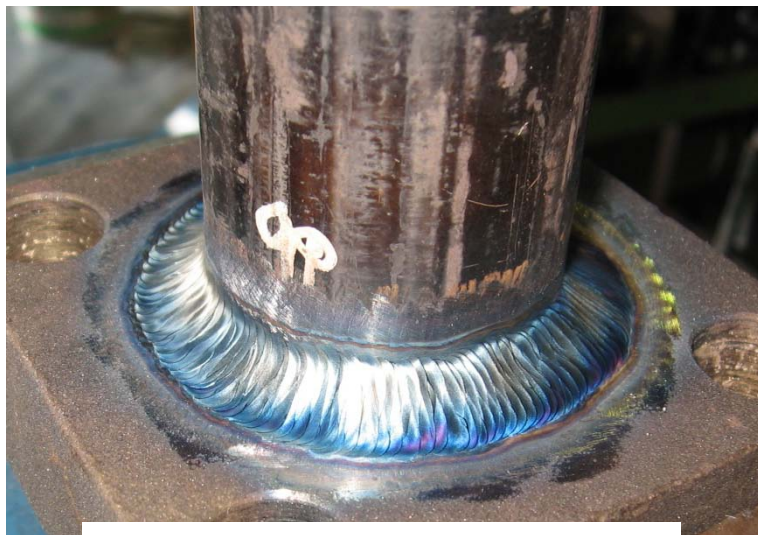
初層から余盛りまでを高度な技術を駆使してオールTIG溶接で行い、溶接欠陥をゼロにします。
