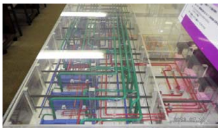
共同溝を張り巡る電力・通信熱供給・給排水の管
